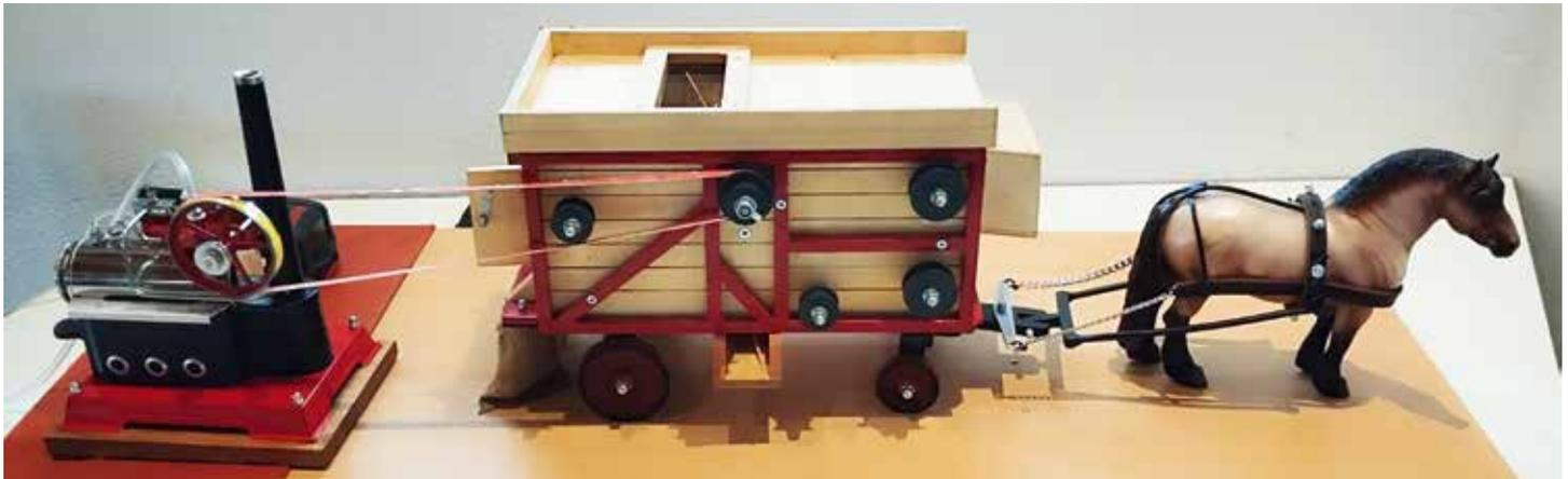
Eine Dampfmaschine treibt die Dreschmaschine an. Auch dieses Modell hat Udo Schwarting aus Hude für das Museum Moorseeer Mühle gebaut.
